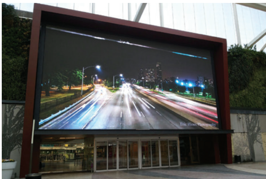
Maior Painel indoor da Península Ibérica em resolução e dimensão 16 x 9mts - 150m 2 ; 120 000 módulos de 320mm x 320mm; 1 228 000 leds SMD
